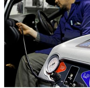
Sistema de diagnóstico de fallas electromecánicas del A/C integrado, con impresión de diagnóstico y solución de problemas.
