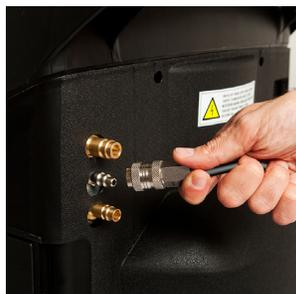
Prueba de fugas del sistema A/C por medio de carga con nitrógeno desde un tanque externo (no incluido) y monitoreo de caída de presión, con alarma de fugas.
